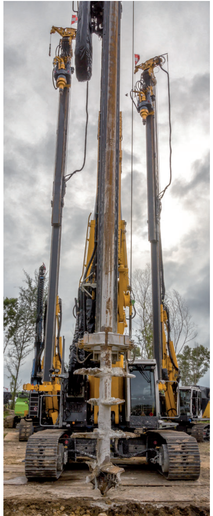
SCM mit KDK 275/MB 155-F an RG 25 S / RG 21 T SCM with KDK 275/MB 155-F on RG 25 S / RG 21 T
