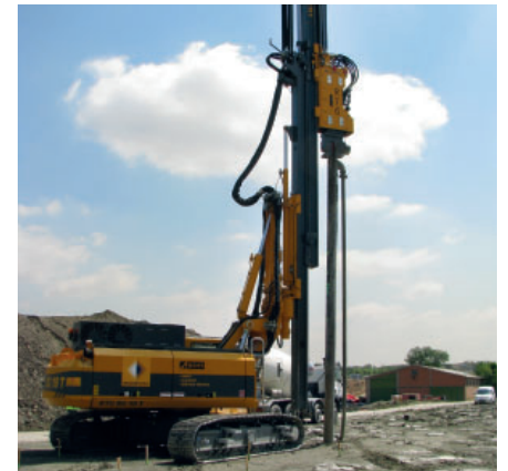
RG 19 T mit Rüttler MR 105V RG 19 T with vibrator MR 105V
