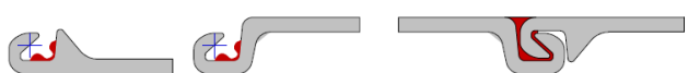
Schloss mit profilierter Dichtung Schloss mit profilierter Dichtung Mittelschloss mit injizierter Dichtung
